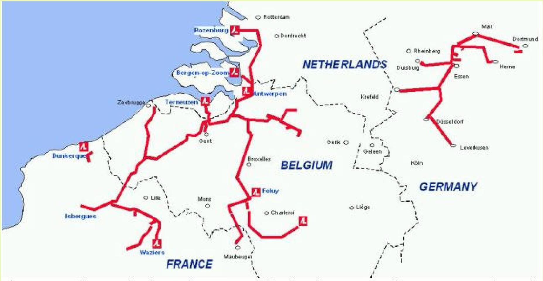
Le gaz circule à 100 bars dans plus de 1100 km de canalisations. La quantité d'hydrogène qui circule est de plus de 50.000 m<sup>3</sup>/h (Air Liquide).
